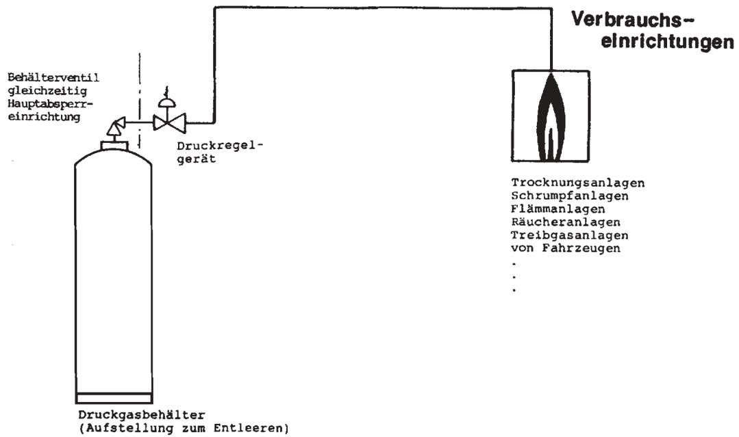
**Bild 1:** Flüssiggasanlage
