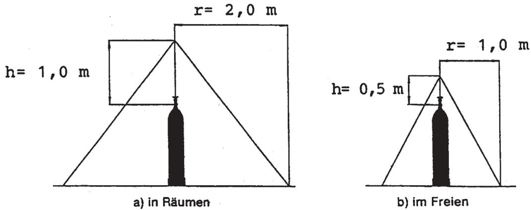
**Bild 2:** Schutzbereiche für Druckgasflaschen mit Flüssiggas
