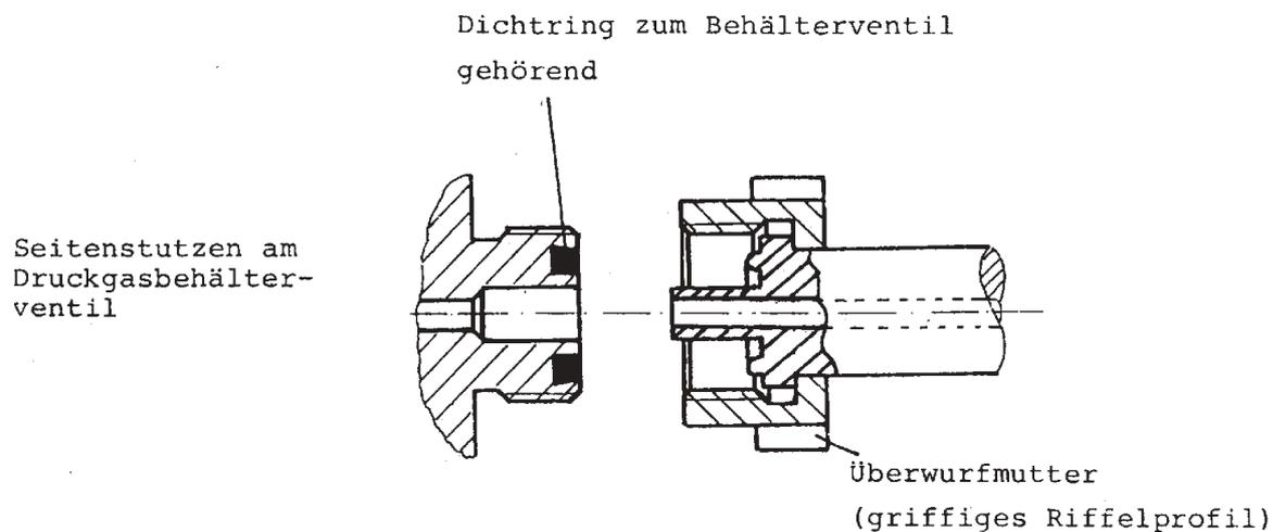
**Bild 5:** Anschluß für Druckgasbehälter mit einem zulässigen Füllgewicht bis 33 kg
