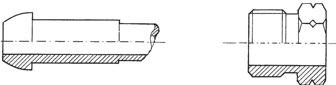
**Bild 6:** Kombinationsanschluß von Druckregelgeräten für Druckgasbehälter mit einem zulässigen Füllgewicht a) bis 14 kg und b) bis 33 kg
