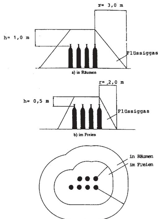
**Bild 3:** Schutzbereiche für mehrere Druckgasflaschen mit Flüssiggas
