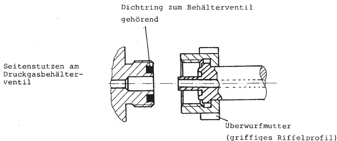
**Bild 4:** Anschluß für Druckgasbehälter mit einem zulässigen Füllgewicht bis 14 kg
