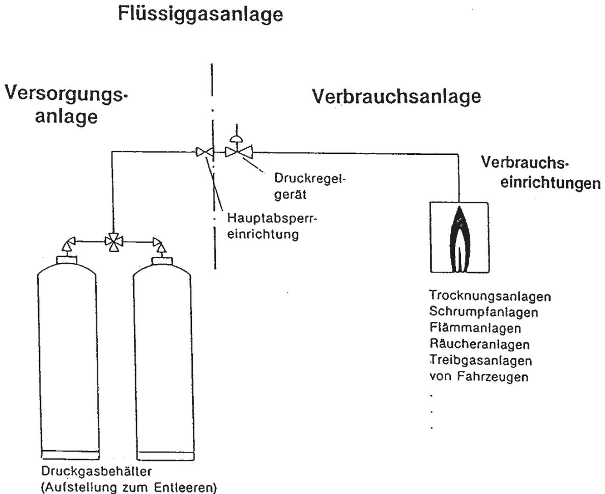
**Bild 2:** Flüssiggasanlage
